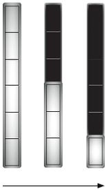
Lorsque la porte de l'appareil est fermée et que le démarrage différé est lancé, les 6 LED s'allument en blanc tamisé. Moins il y a de LED blanches tamisées, moins il reste de temps avant que le programme ne démarre.
